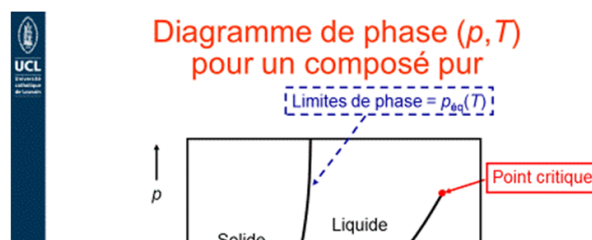
FIGURE 4 – Ligne d'équilibre de phase liquide-vapeur et application de la relation de Clapeyron (source : Syllabus J. Proost, p. 16).
